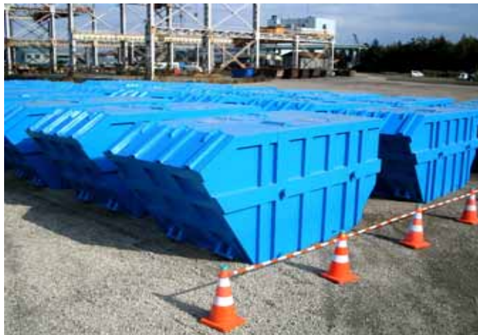
写真4 造粒運搬物運搬時の飛散流出対策 (カバー付きラガーバック)
